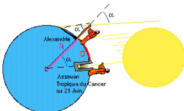
Eratosthène a déterminé le premier rayon terrestre en mesurant l'angle entre les verticales d'Assouan et d'Alexandrie et la distance qui les sépare.
